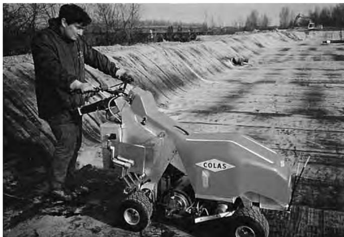
Photo 7 Machine à contrôler les joints par ultrasons CAC 94. / *Equipment to control joints by ultrasounds CAC 94*
