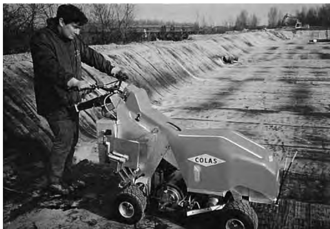
Photo 7 Machine à contrôler les joints par ultrasons CAC 94. / Equipment to control joints by ultrasound CAC 94
